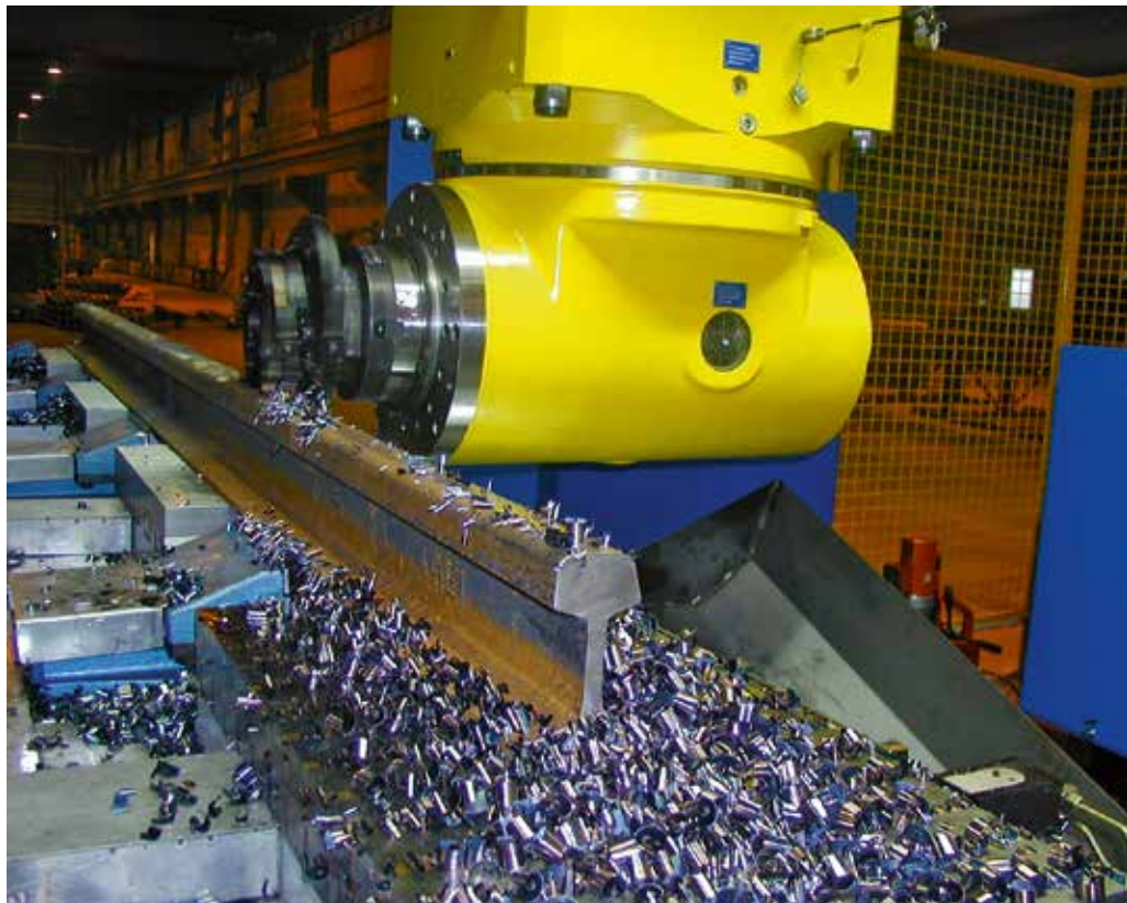
2 ... sondern beinhaltet auch neue, gehärtete Führungsleisten und einen kraftvollen 135 kW-Winkelfräskopf (© Rottler)
