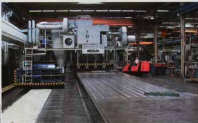
Gantry-Portalfräsmaschine für die Hochgeschwindigkeits-Aluminiumbearbeitung ist modular aufgebaut und deshalb leicht zu warten.
