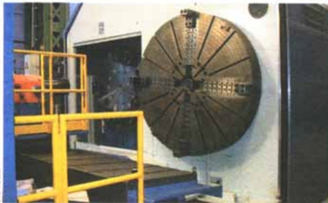
Modernisierung einer Plandrehmaschine.
